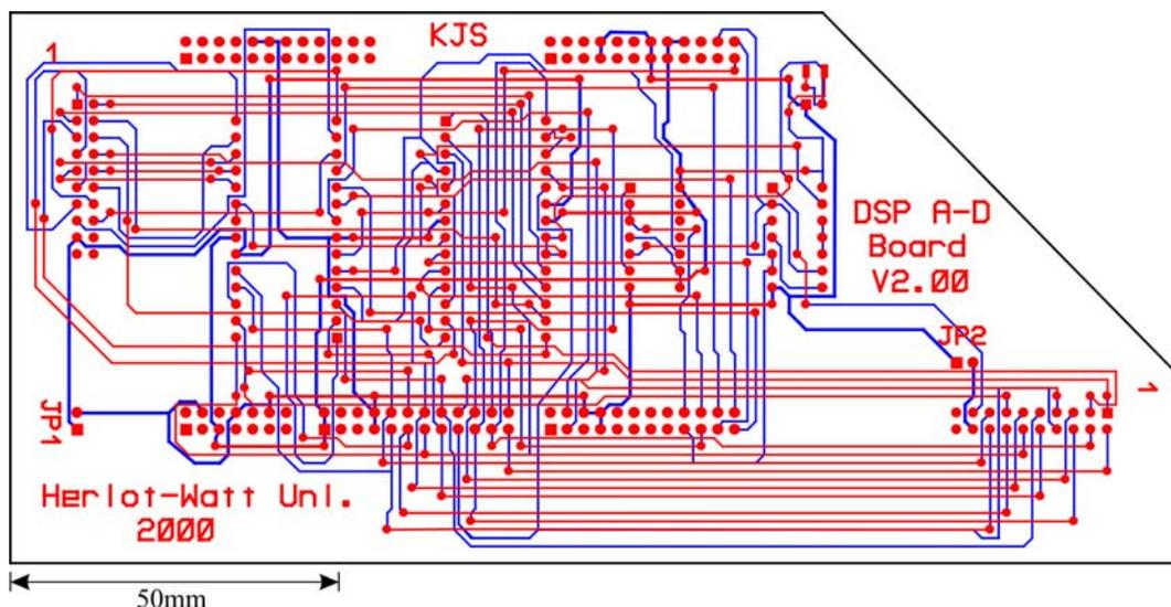
**Figure 95: DSP Module PCB Layout**
